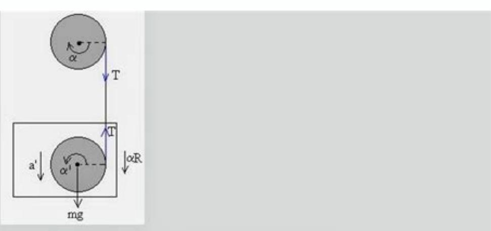
Movimiento del disco superior fijo. Ecuación de la dinámica de rotación
